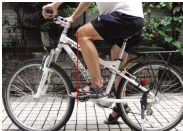
圖三、坐墊前後位置：由側面觀，騎者膝蓋前緣往下的垂直線應剛好通過踏板軸。
