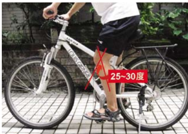
圖二、正確的坐墊高度：當騎者坐在坐墊上且腳踩踏板在曲柄的最低點時，騎者的膝蓋呈25至30度的屈曲。
