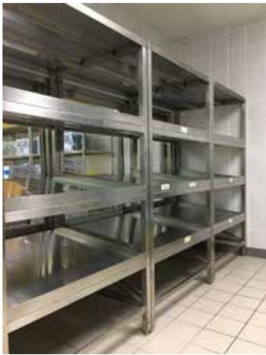
▲ 管灌品層架採斜式設計，方便物品上架與取用
